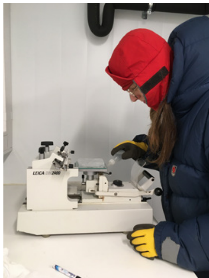
Klargjøring av tykke og tynne seksjoner fra en iskerne med mikrotom. Foto: Sebastian Gerland / Norsk Polarinstitutt
